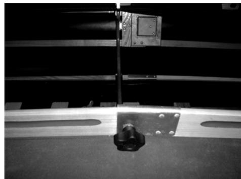
Gleichzeitig werden die Rückenlehnen jeweils durch das 3. und 6. Loch des Waschbordes gesteckt und ebenfalls leicht angeschraubt (**Bild11**). (analog dazu die Waschbordteile VR und HR)
